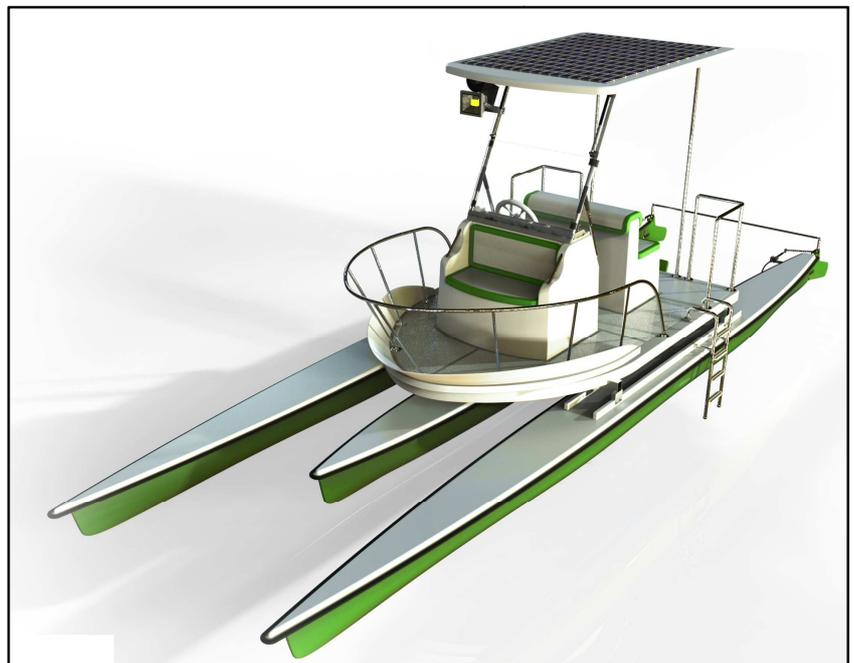
Lo scafo è stato costruito e stratificato con il sistema sandwich ed è lungo 7,70 metri con una larghezza di 2,40 metri. Pesa 240 kg. e con il sistema di propulsione elettrica, il peso raggiunge i 650 kg
